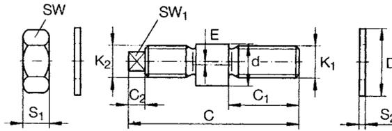
Zentrische Zapfen in korrosiongeschützter Ausführung: LFE...VA.
