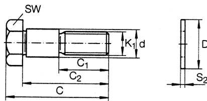
Zentrische Zapfen in korrosiongeschützter Ausführung: LFZ..VA.
